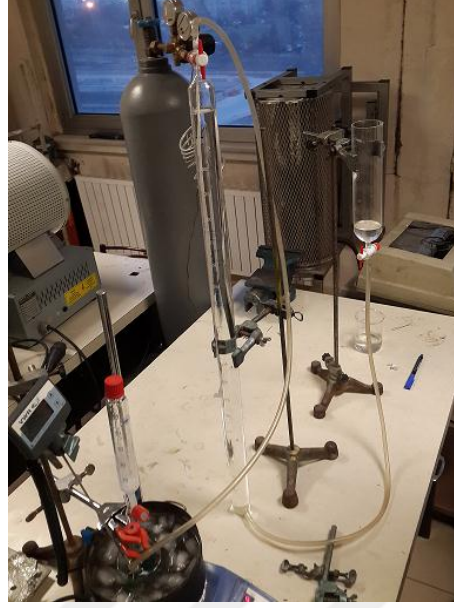
Şekil 3.2 Nikel borür sentezinde ortaya çıkacak hidrojen hacmini ölçmek amacıyla kurulan gaz büret sistemi
