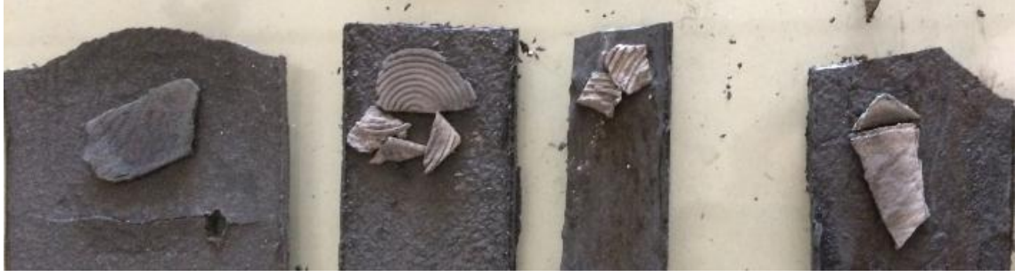
Şekil 4.15 Sinterlenmiş anot şeritler, soldan sağa sırasıyla katkısız ham şerit, % 1 Ni 2 B katkılı ham şerit, % 2 Ni 2 B katkılı ham şerit ve % 3 Ni 2 B katkılı ham şerit
