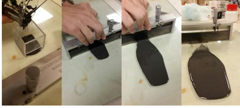
Şekil 4.1 Ham şerit çamurunun doktor bıçağı ile cam yüzeye çekilmesi
