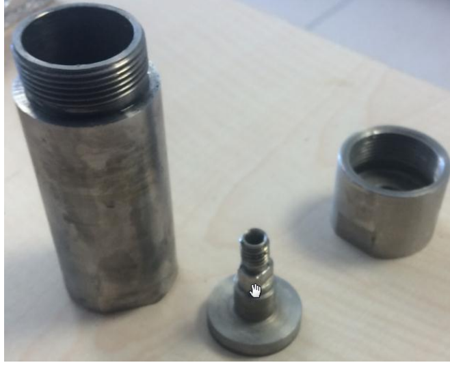
Şekil 3.3 Solvo-Termal yol ile sentez sırasında kullanılan 35 mL hacmindeki reaktör
