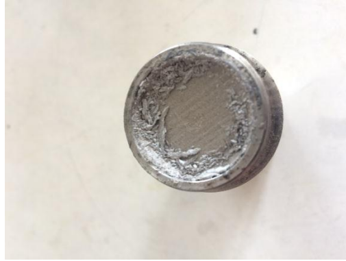
Şekil 5.1 Solvo-Termal deneyde reaktör için kullanılan ve parçalanmış ısıl conta
