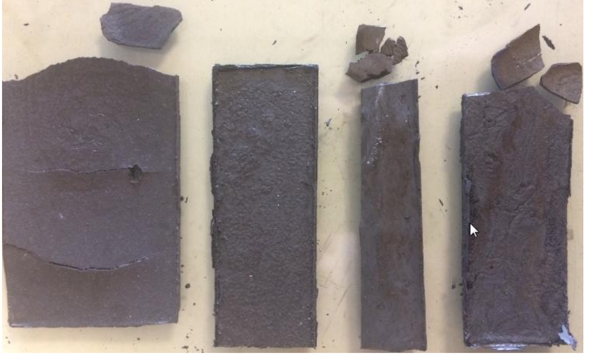
Şekil 4.14 Sentezlenen ham şeritler, soldan sağa sırasıyla katkısız ham şerit, % 1 Ni 2 B katkıli ham şerit, % 2 Ni 2 B katkıli ham şerit ve % 3 Ni 2 B katkıli ham şerit
