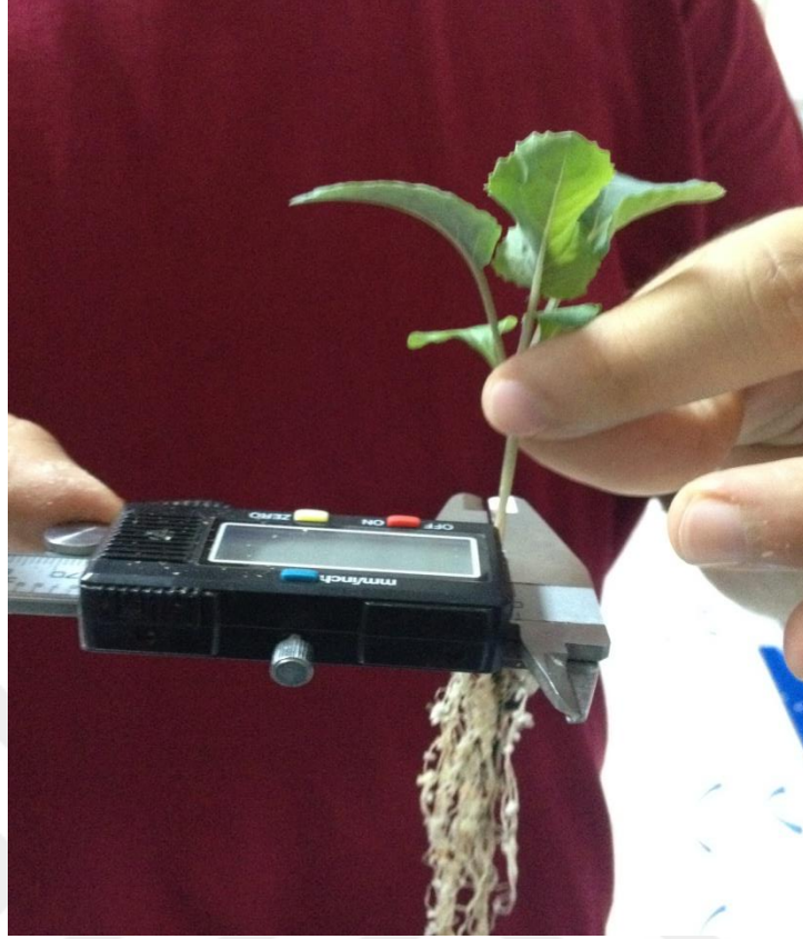
Şekil 3.7 Gövde çapının ölçümü
