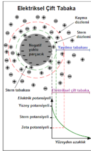
Şekil 2.2 Kolloidal bir sistemde oluşan potansiyel fark (zeta potansiyel ) (Anonim 2020b)
