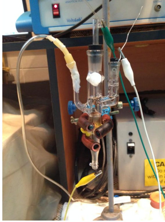
Şekil 3.2 İnert atmosferde elektropolimerizasyon düzeneği
