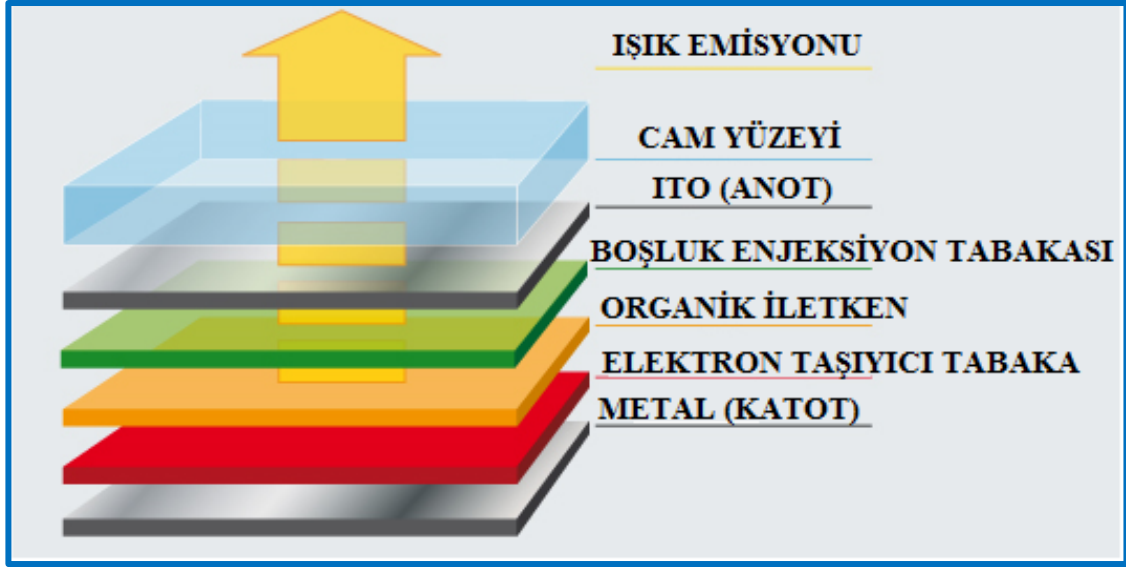
Şekil 2.10 Organik ışık saçan diyotların (OLED) çalışma prensibi
