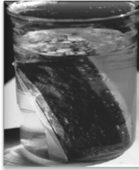
Şekil 2.13 Tuzlu suda 3 sene boyunca bekletilen polianilin kaplı çelik numunesi
