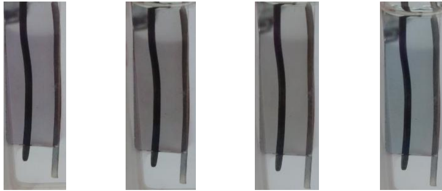
Şekil 5.23 Polimer-2'nin optoelektrokimyasal spektrumu ve renk değişimi
