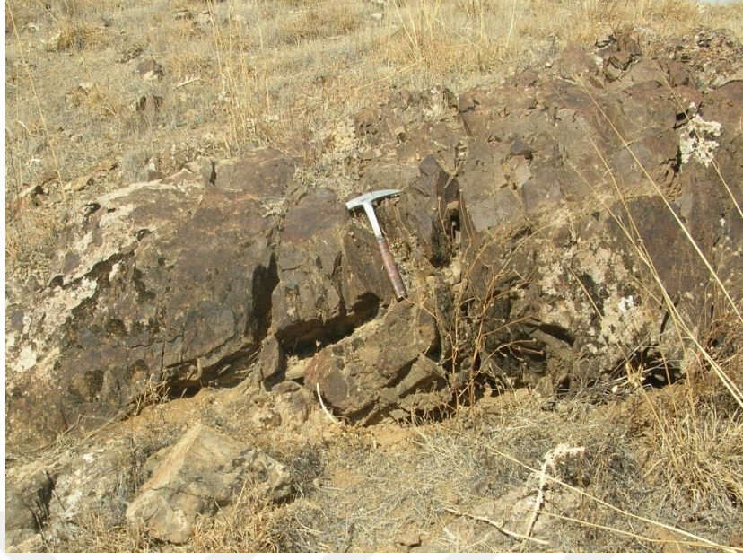
Şekil 6.5 d 1 - d 1 ' kesitinde yer alan granat skarnın (endoskarn-prograd evre) mostra görüntüsü
