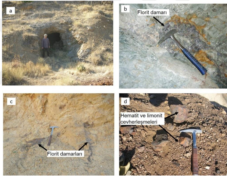
Şekil 6.1 Sarılımağara tepesinin kuzeydoğusunda gelişen cevherleşmeler a. alanın yakınındaki gözlem galerisi, b. galeri içerisinde izlenen 5-10 cm kalınlığındaki florit damarı ve sarı-yeşil renkli alterasyon zonları, c. mostrada görülen ince-orta kalınlıktaki florit damarları, d. galeri pasasında oluşmuş hematit ve limonit cevherleşmeleri
