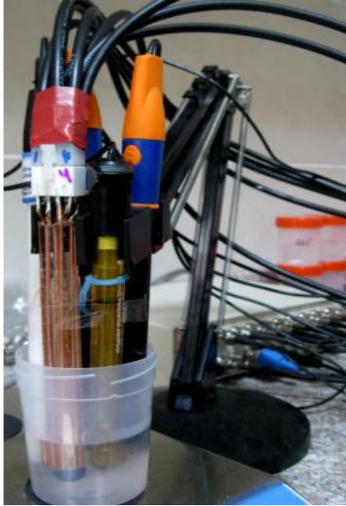
Şekil 3.3 Multiplexer cihazına bağlı elektrot dizini
