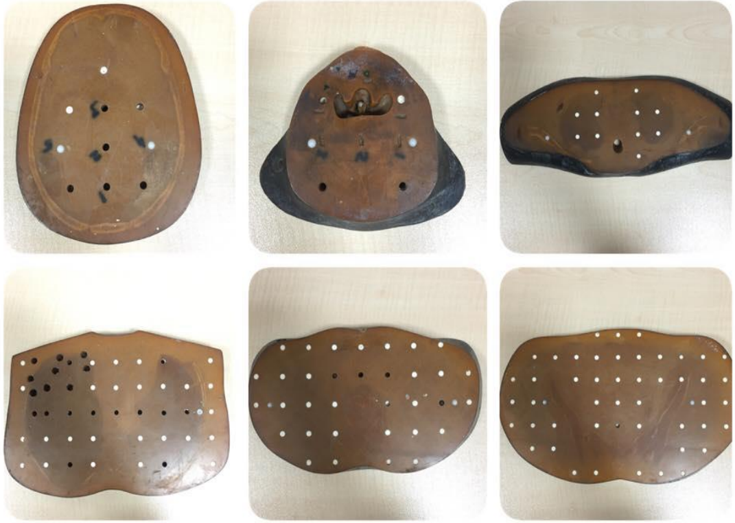
Şekil 3.12 Orta hat ve cilt dozlarının ölçüldüğü rando fantom kesitleri
