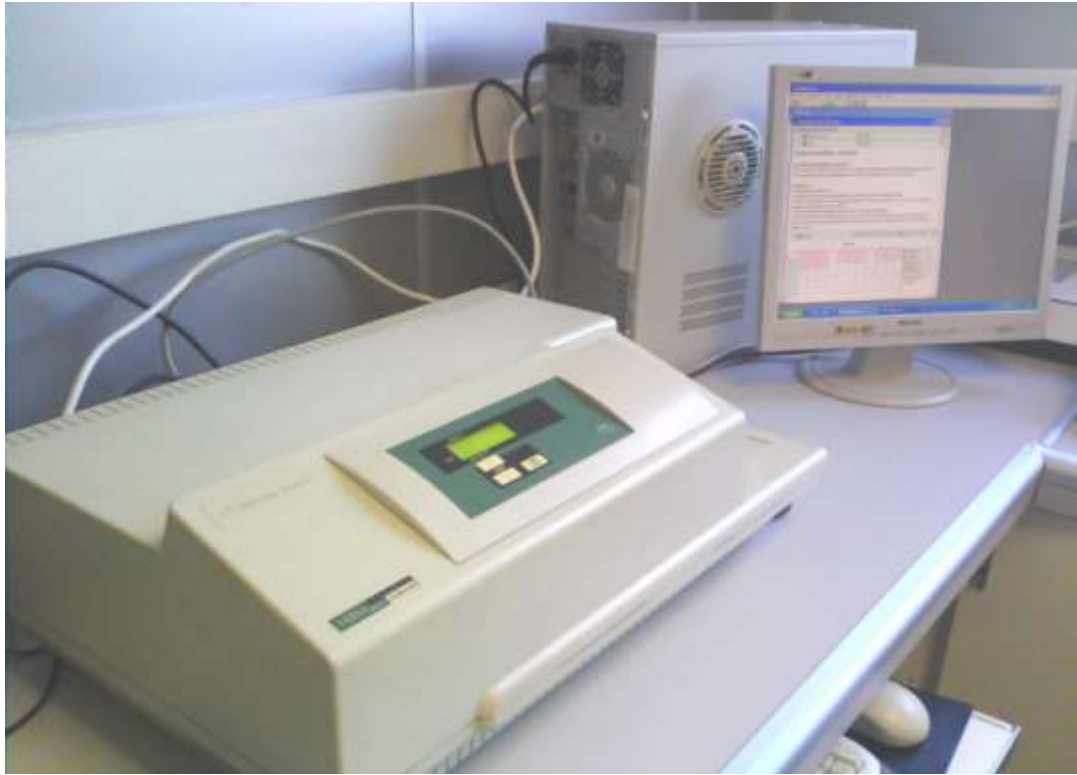
Şekil 3.5 Biyoassaylerde kullanılan Spectrophotometer (VERSAmax Kinetik Mikroplaka okuyucu)
