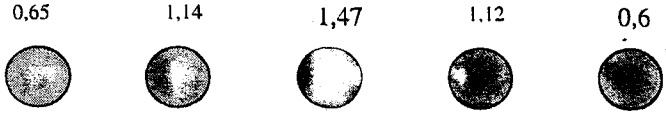
Şekil 3.27. X-ışınının doğru olarak merkezlenmesi ile elde edilen görüntü. Merkezdeki deliğin maksimumyoğunluğa sahip olduğu ve diğer deliklerin yoğunluklarının simetrik olarak azaldığı görülmektedir (odak nokta-film mesafesi = 100 cm)
