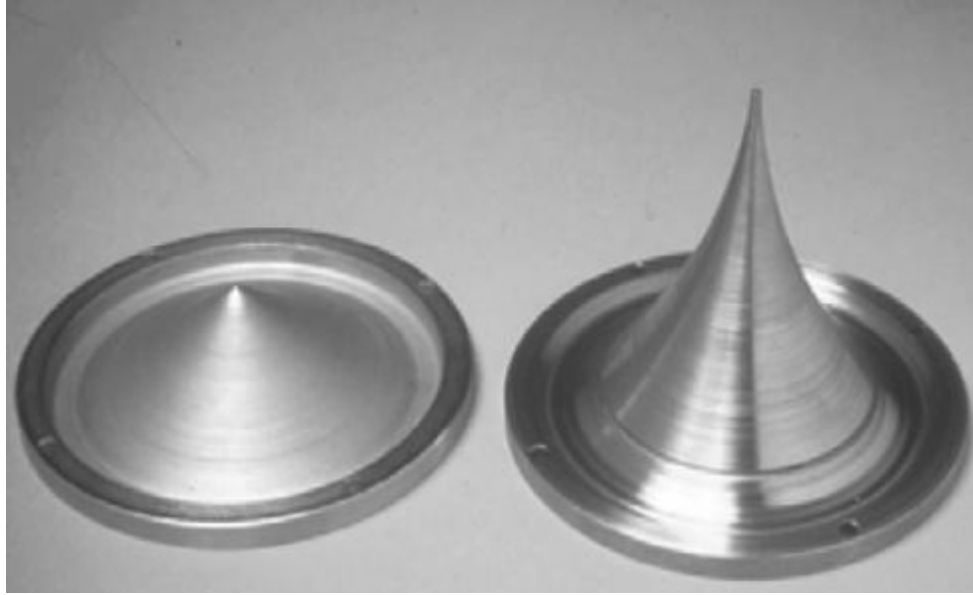
Şekil 2.3 Farklı enerjiler için tasarlanmış düzleştirici filtreler
