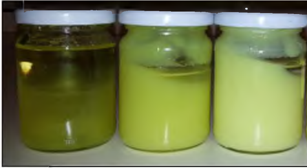
Şekil 3.8. Dondurma-eritme döngüsü esnasında bozulan yağlı jellerin görüntüsü (Soldan sağa FLJ 2 , FLJ 3 , FLJ 4 ).
