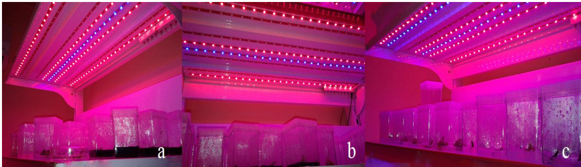
Şekil 4.1. Farklı LED ışık uygulamaları (a) 4 kırmızı:1 mavi (b) 3 kırmızı:1 mavi ve (c) 2 kırmızı:1 mavi ışık kombinasyonu
