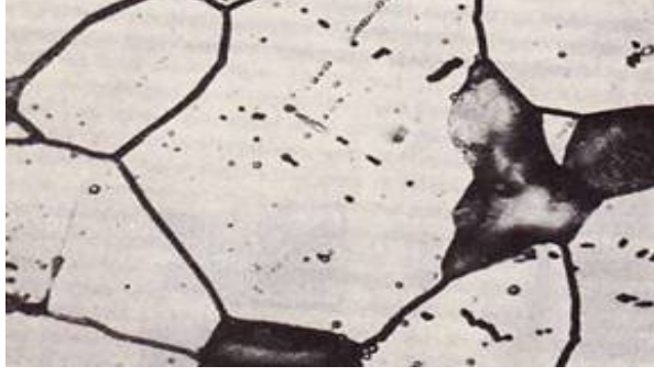
Şekil 2.19 Paslanmaz çeliğin sülfat- sülfürik asit çözeltisinde 27 saat bekletilmesi sonucu oluşmuş korozyon
