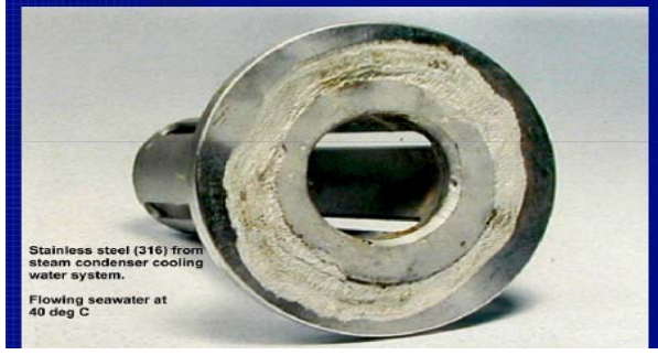
Şekil 2.5 Aralık korozyonu
