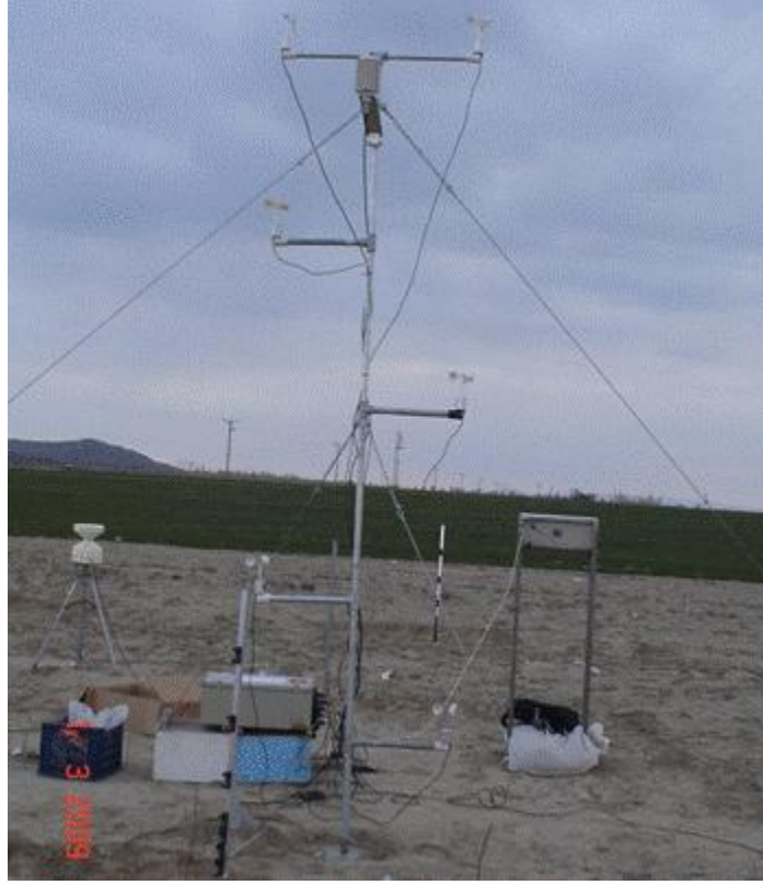
Şekil 3.4 Karapınar’da rüzgâr erozyonu araştırması için kurulan meteoroloji istasyonu
