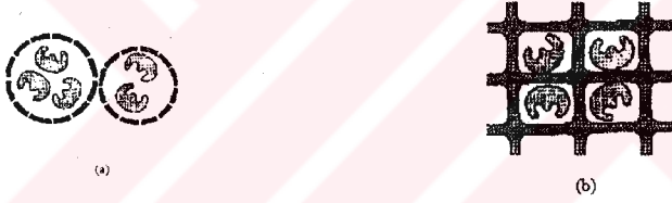
Şekil 2.3. Enzim tutuklanması a) Mikrokapsülasyon b) Kafes tutuklanması
