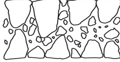
Fig. 5: Şematik çift kabuklu duvar çizimi.
