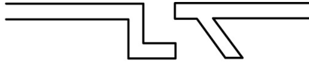
Fig. 13: Şematik dolaylı kapı çizimi.
