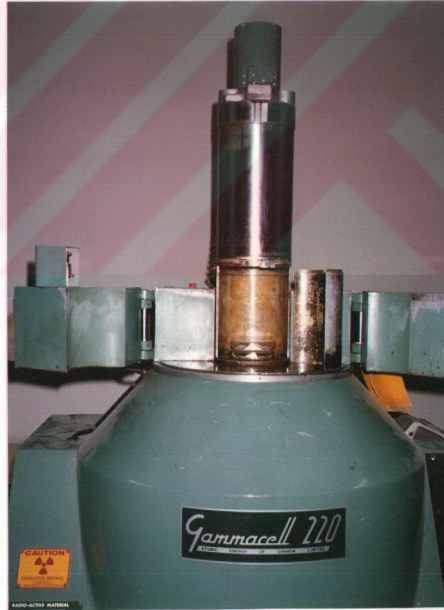
Şekil 3.8. O.nubilalis pupalarının ışınlanmasında kullanılan gamma radyasyonu kaynağı ve içerisinde pupa bulunan petri kutularının yerleştirilmesi.
