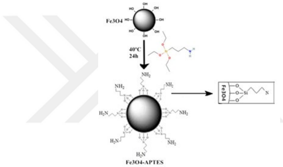
Şekil 4.1 APTES ile fonksiyonelleştirilmiş \text{Fe}_3\text{O}_4 nanoparçacıklarının şematik gösterimi (Feng vd. 2016)
