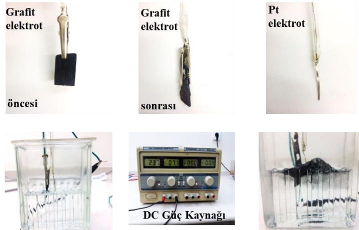
Şekil 4.3 Elektrokimyasal grafit üretiminde kullanılan elektrotlar, elektrokimyasal hücre ve doğru akım güç kaynağı
