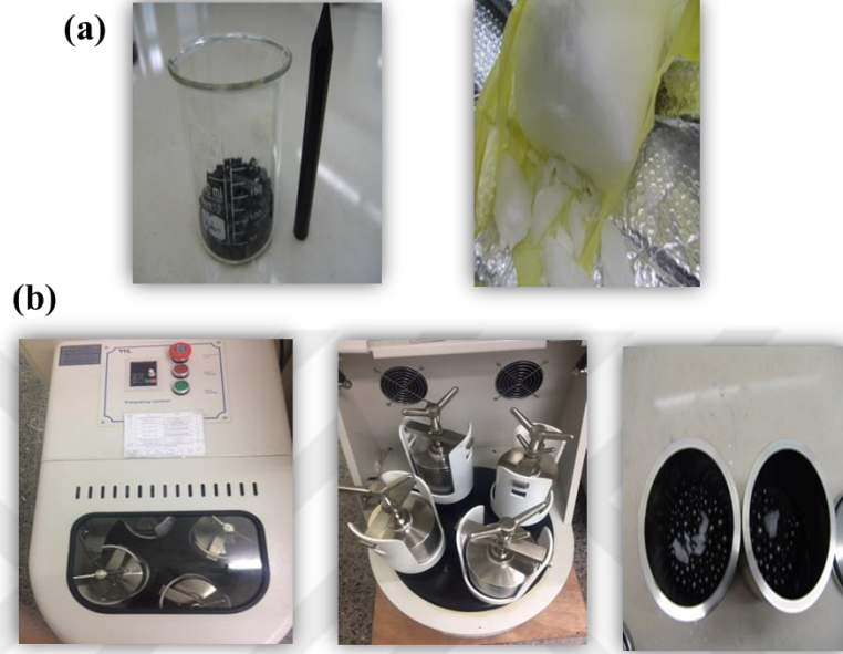
Şekil 3.3 Mekanokimyasal yöntemle grafen üretiminde kullanılan (a) kalem formundaki grafit ve kuru buz (b) plenary bilyalı değirmen ve paslanmaz çelik hücrelerin dijital görüntüleri
