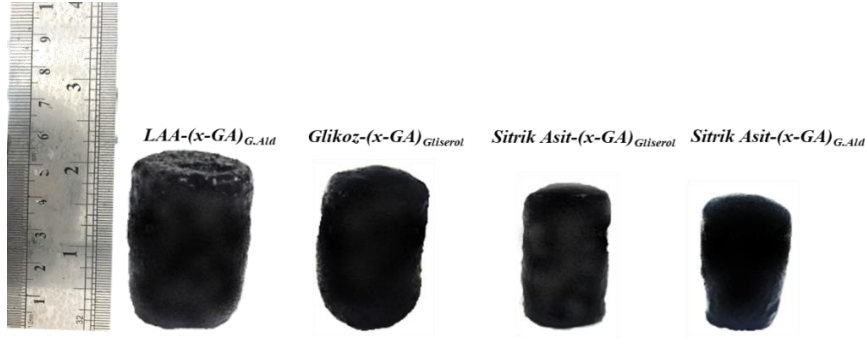
Şekil 4.60 Çapraz bağlayıcı ve indirgeyici ajan kullanılarak elde edilen bazı 3D grafen yapıların dondurarak kurutma sonrası çekilmiş dijital görüntüleri
