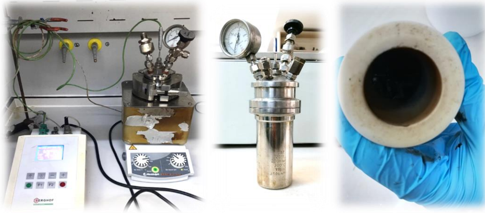
Şekil 3.10 Hidrotermal indirgeme kaynaklı birleşme ile 3D grafen üretim yönteminde kullanılan teflon kaplı paslanmaz çelik reaktör ve teflon kap
