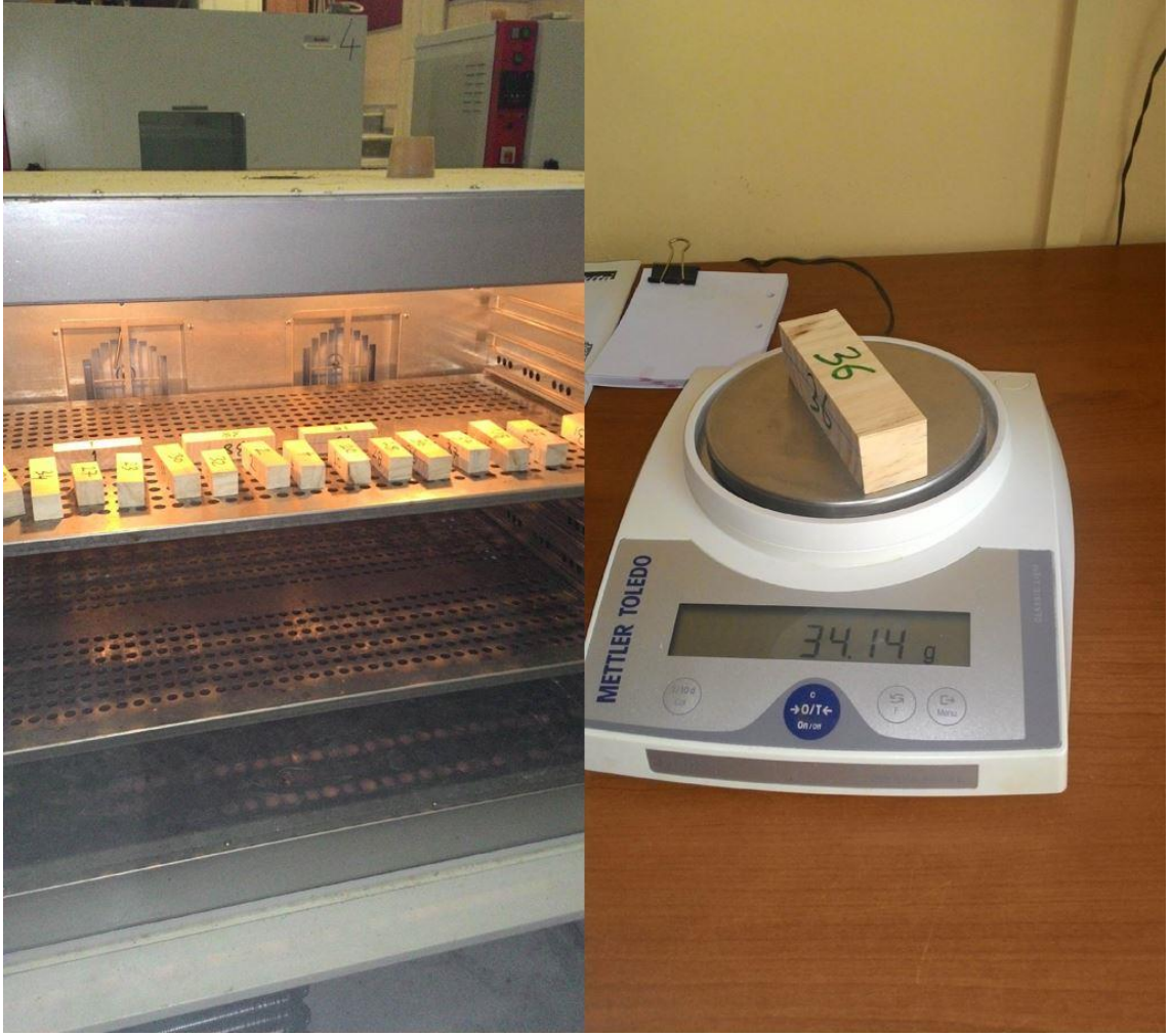
Şekil 3.18 Tam Kuru Odun Elde Etmek için Ön İşlem Uygulaması (26.7.2016)
