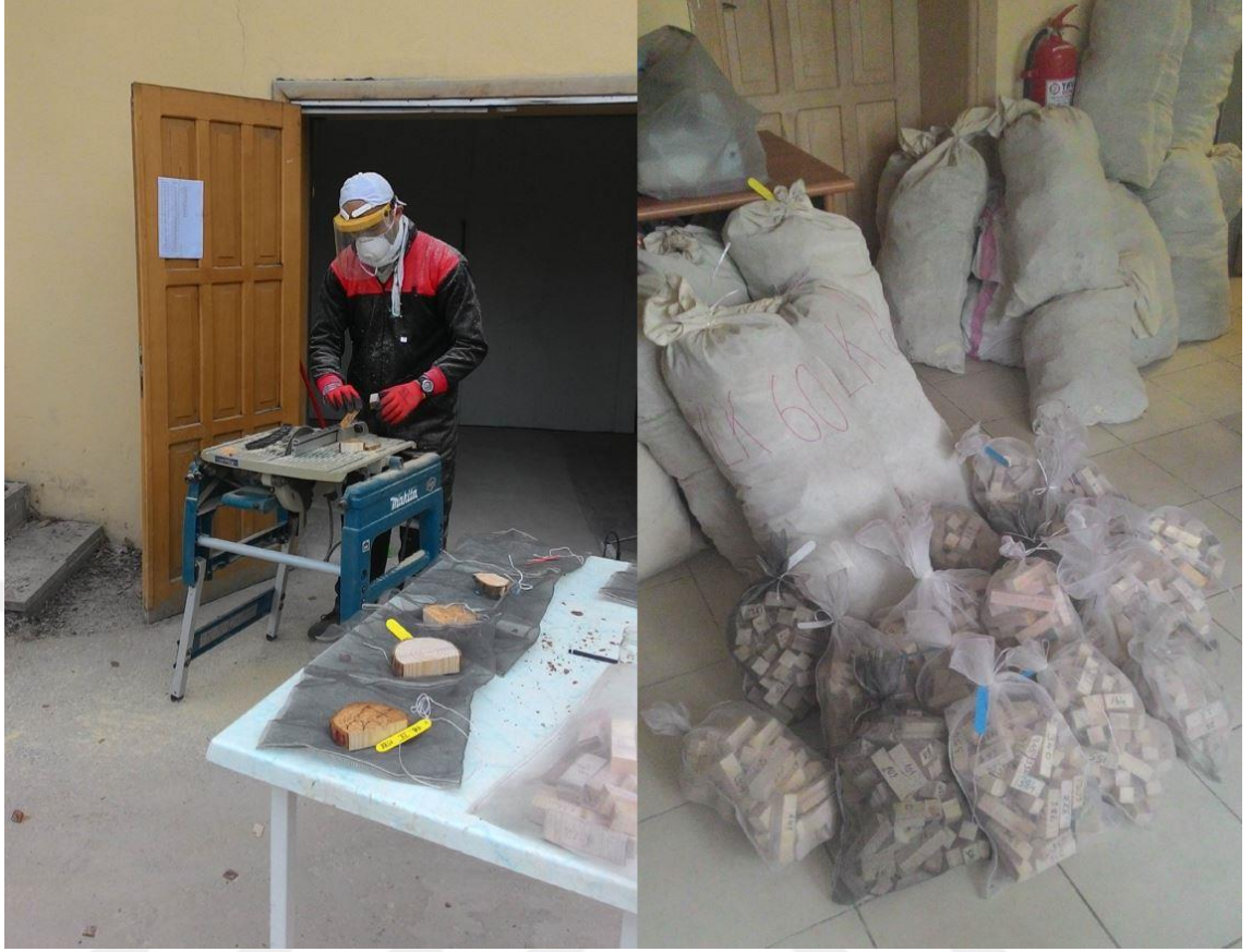
Şekil 3.17 Yıllık Halka Ölçümleri Tamamlanan Örneklerin Hacim Ağırlık Ölçümü için Yeniden Kesimi (21.7.2016)
