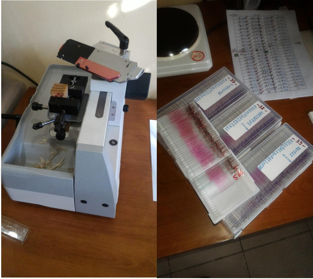
Şekil 3.22 LEICA SM 2010 R Mikrotom ve Hazırlanmaları Devam Eden Preparatlar (19.6.2018)
