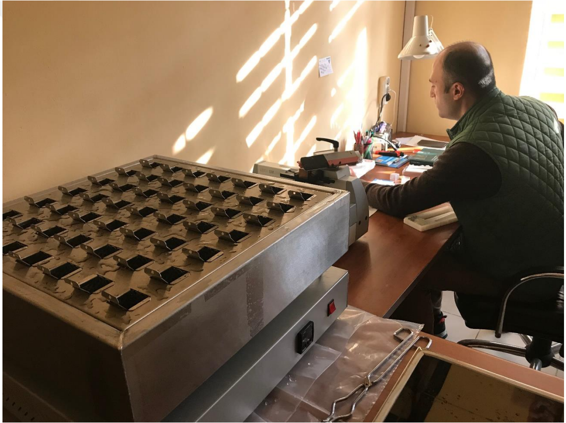
Şekil 3.20 Kesit Alımı için Örneklerin Doku Hazırlama Cihazıyla Yumuşatılması (17.10.2017)
