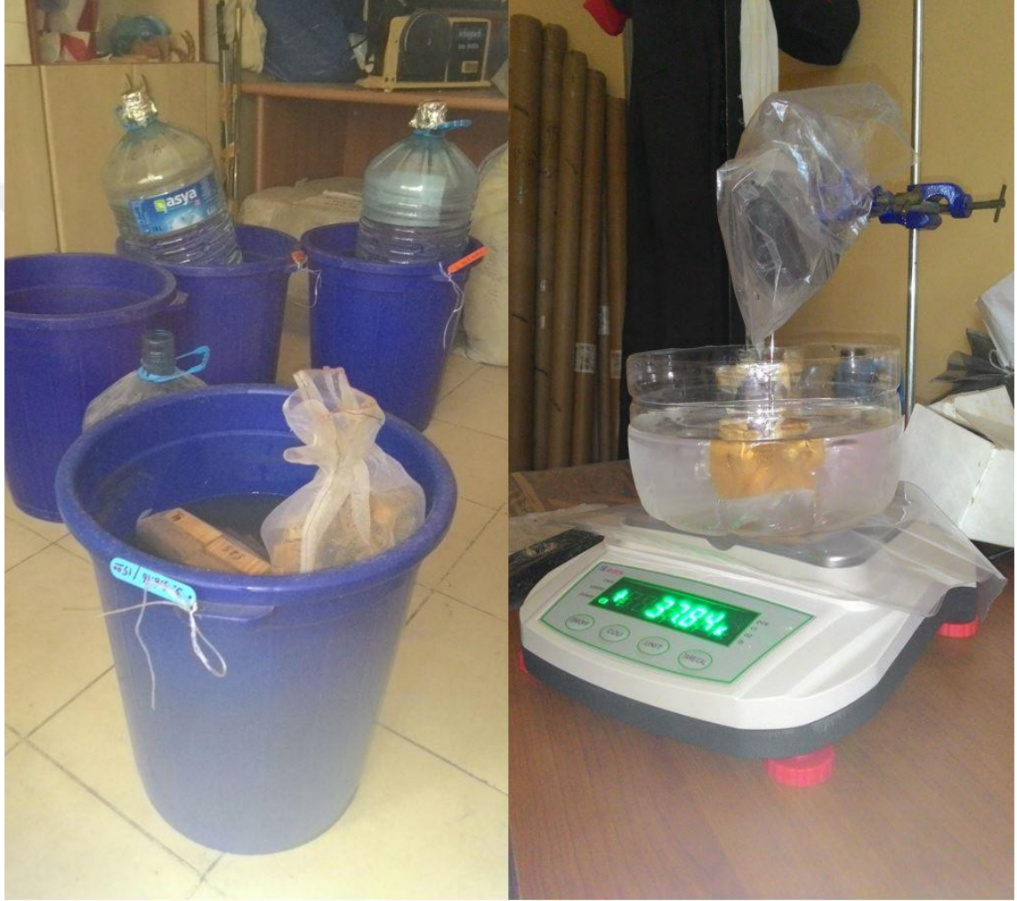
Şekil 3.19 Örneklerin Tam Yaş Nem Düzeyine Getirilmesi ve Hacimlerinin Tartılı Daldırma Yöntemiyle Ölçümü (23.8.2016)
