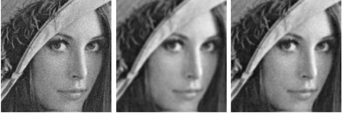
Şekil 3.5 a) Gürültülü görüntü, b) standart ortalama filtresi kullanılmış, c) ağırlıklı ortalama filtresi kullanılmış
