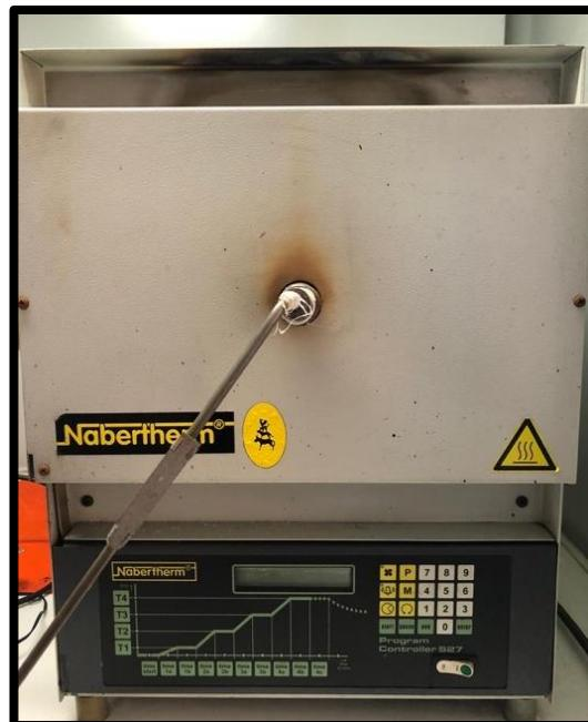
Şekil 3.2 Karbonizasyon işleminin gerçekleştirildiği sıcaklık programlı ıslı işlem fırını
