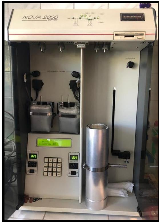
Şekil 3.4 Quantachrome Nova 2200 serisi volumetrik gaz adsorpsiyon cihazı
