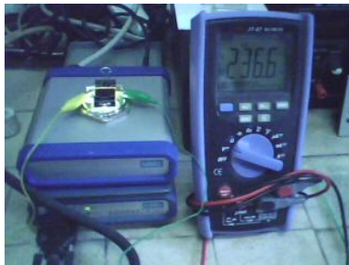
Şekil 3- BLe ligandının ölçülen potansiyelinin voltmetre ile gösterimi.
