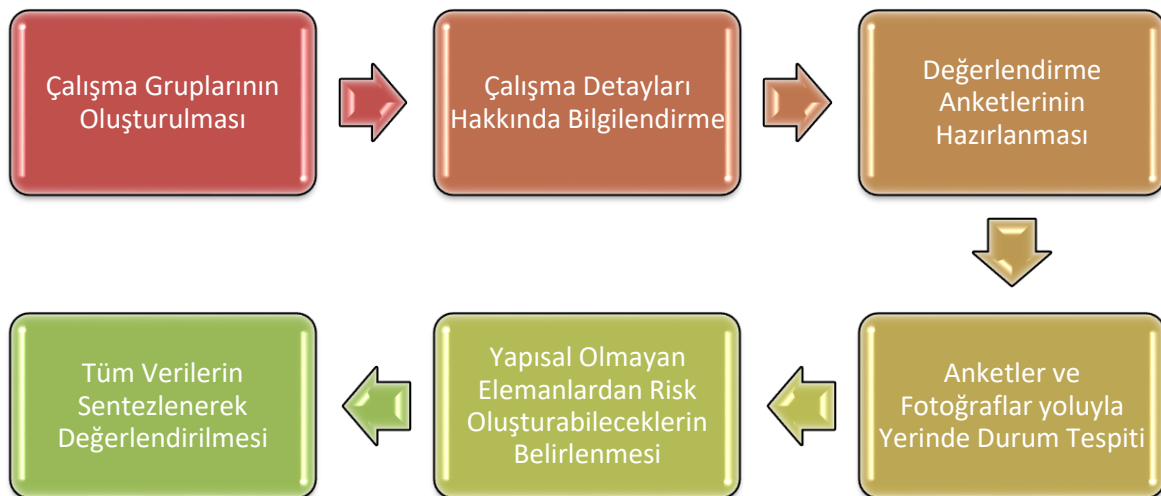
Şekil 3. Okullarda Yapısal Olmayan Risklerin Tespitinde İzlenen Yol
