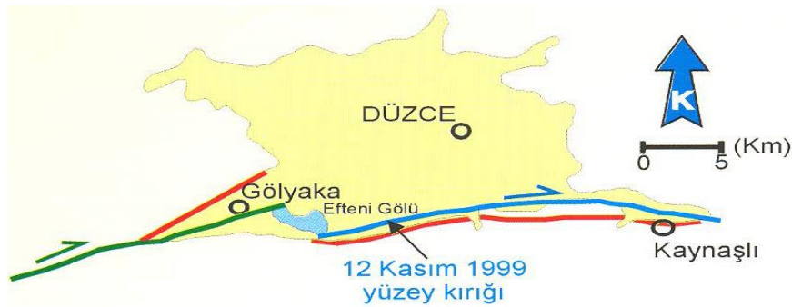
Şekil 1. Kuzey Anadolu Fay Hattının 17 Ağustos ve 12 Kasım 1999 depremleri yüzey kırığı ile birlikte tek bir hat olarak davranmaya çalışması (Ulusoy, R. 2000)
