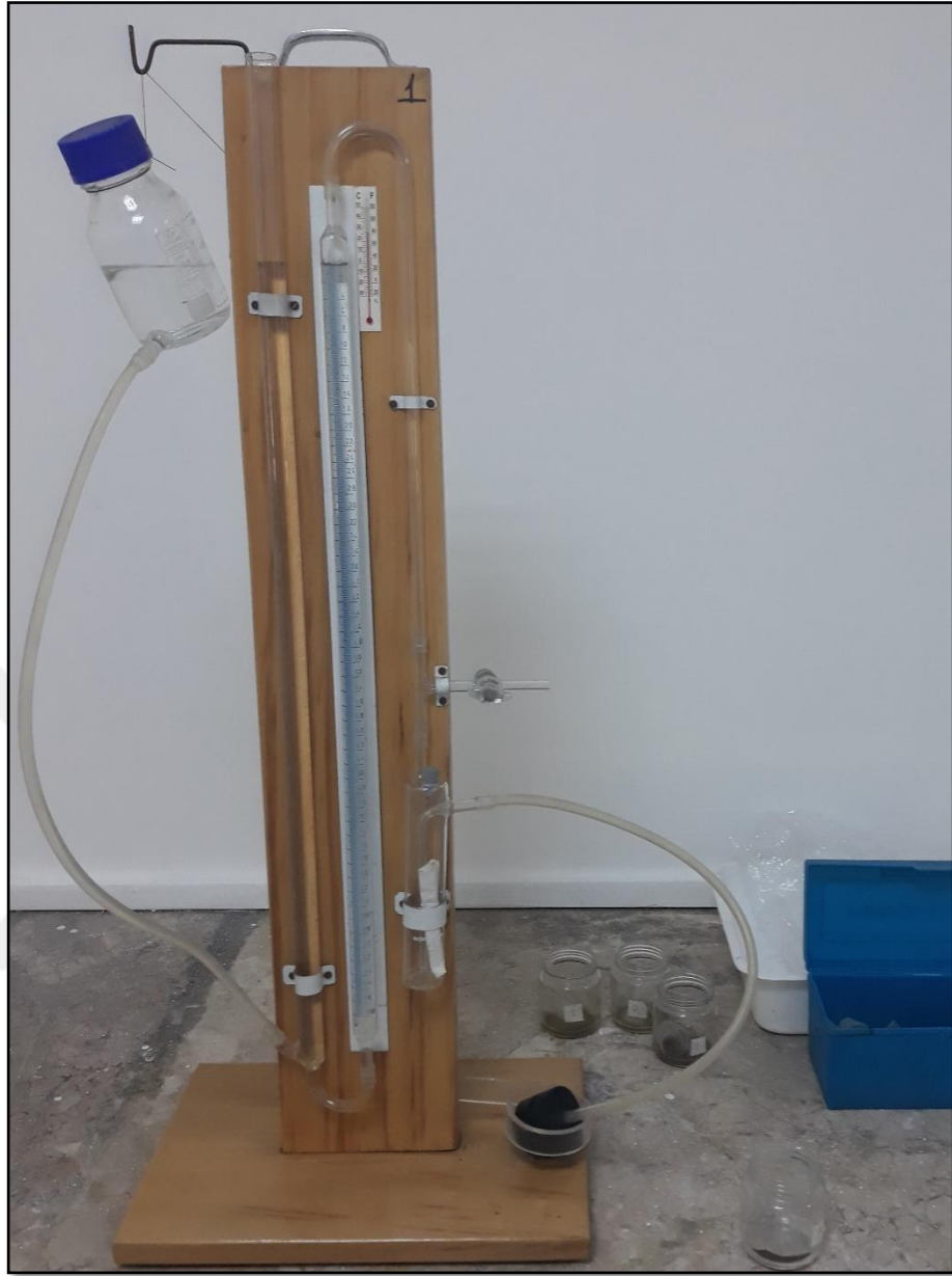
Şekil 3.18 Scheibler kalsimetresiyle kireç analizinin yapılışı
