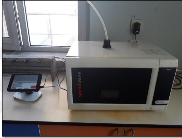
Şekil 3.9 Yakma işleminin yapıldığı mikrodalga örnek parçalayıcı
