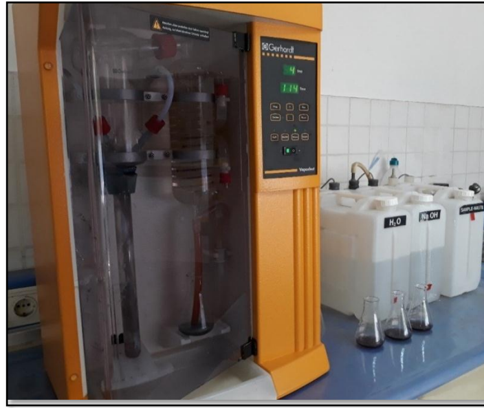
Şekil 3.20 Örneklerin Kjeldahl yöntemine göre N miktarı tayini
