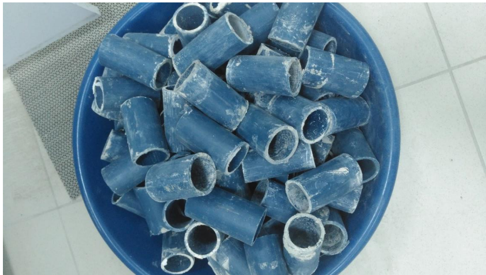
Şekil 3.36 Jet grout numuneleri için kullanılan PVC kalıplar
