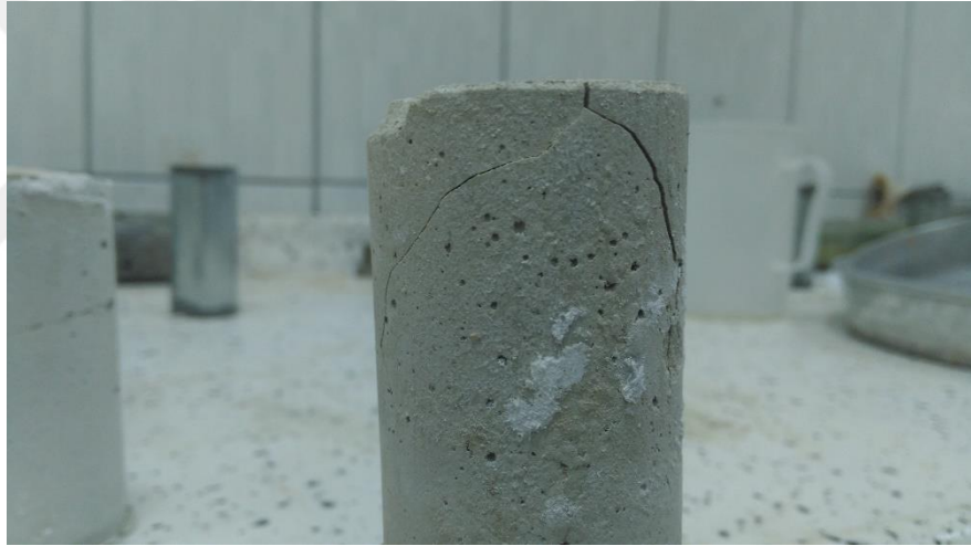
Şekil 4.6 6000 mg/l sülfata 120 gün maruz kalmış Portland çimentolu numune
