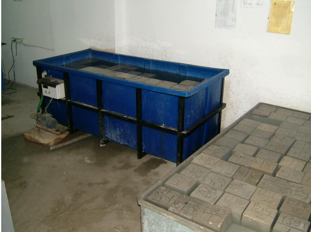
Şekil 3.32 Beton numunelerinin sülfatlı sulara maruz bırakılarak test edilmesi
