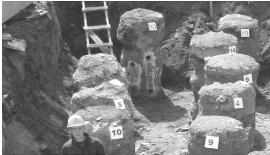
Şekil 3.23 Deneme kolonlarının açığa çıkartılara çap ölçümü yapılması
