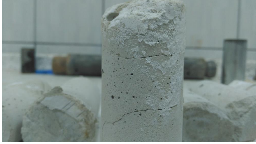
Şekil 4.3 12000 mg/l sülfata 120 gün maruz kalmış Normal Portland çimentolu numune
