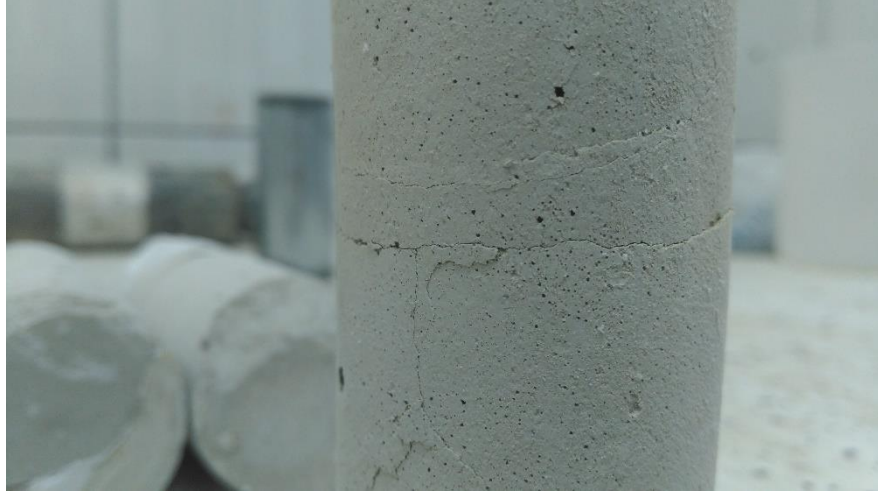
Şekil 4.5 6000 mg/l sülfata 90 gün maruz kalmış normal Portland çimentolu
