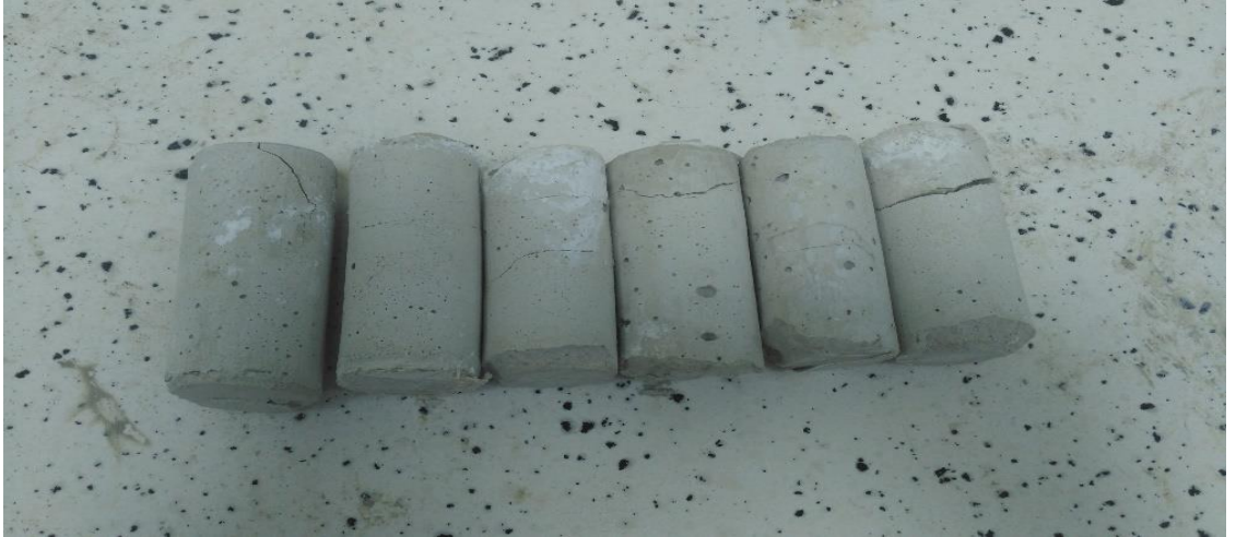
řekil 4.2 Kür ierisinde 90 gün bekleyen numunelerde meydana gelen morfolojik deđiřiklikler
