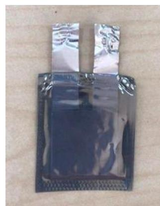
Şekil 4.4 Paketlenmiş  $4 \text{ cm}^2$  alanlı süperkapasitörün fotoğrafı
