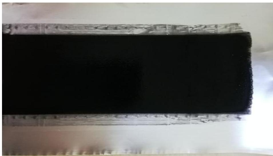
Şekil 4.1 Dr. Blade mekanizması ile üretilmiş 150  $\mu\text{m}$  malzeme kalınlıklı elektrotun fotoğrafı
