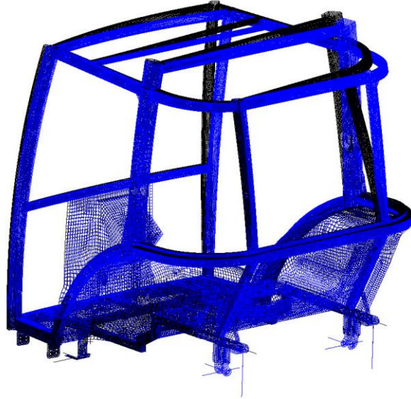
Şekil 4.73 Simülasyon 4 arka yükleme (110 mm) yük durumu sınır koşulları
