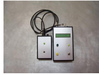
Fotoğraf 2 QCM sistemi - Portatif frekansmetre, osilatör ve 10 MHz kuartz kristali
