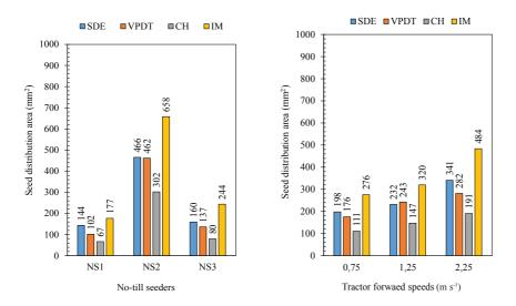
**Figure 8- Effects of no till seeders and tractor forward speeds on the seed distribution area** *Şekil 8- Anıza doğrudan ekim makinaları ve traktör ilerleme hızlarının tohum dağılım alanlarına etkileri*
