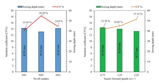
Figure 7- Effects of no-till seeders and tractor forward speeds on the sowing uniformity Şekil 7- Anıza doğrudan ekim makinaları ve tractör ilerleme hızlarının ekim düzgünlüğüne etkileri
