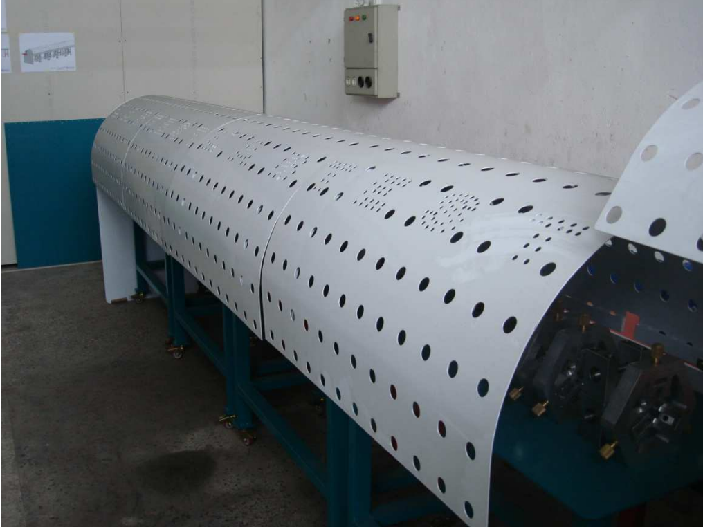
Şekil 2-5: Haddeme sisteminin kapalı hali
