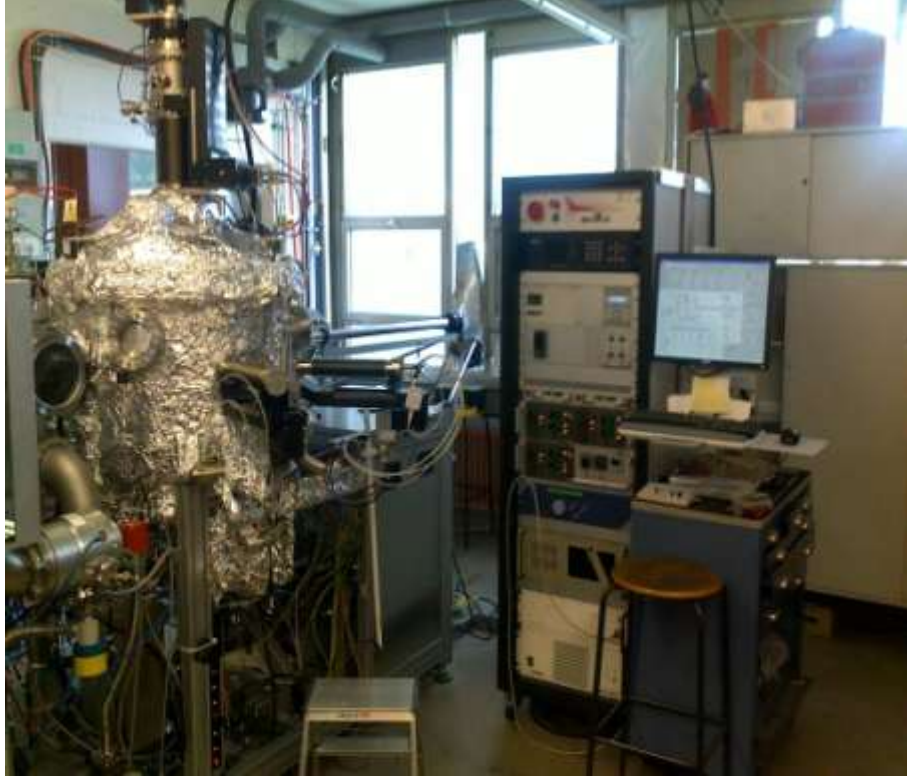
Şekil 3.3 Bielefeld Üniversitesi Nano Fizik bölümünde bulunan manyetik alanda sıçratma sistemi- (BESTEC) sisteminin görünümü
