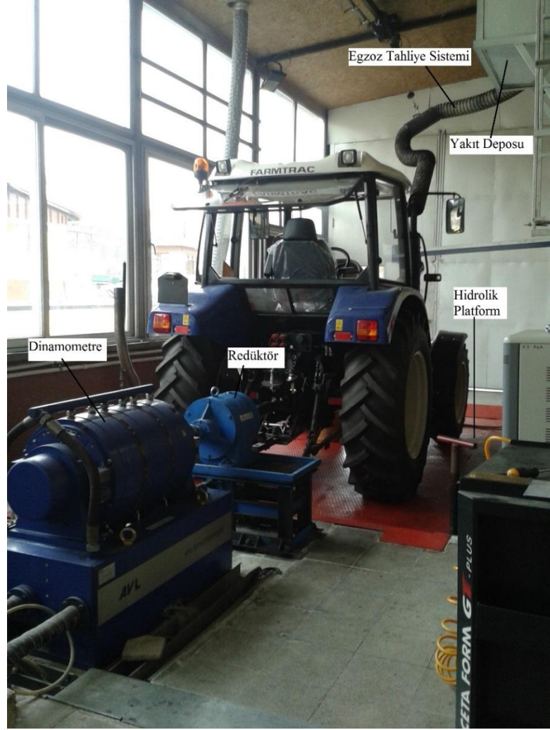
Şekil 3.1 OECD Kod 2 kuyruk mili performans test sistemi
