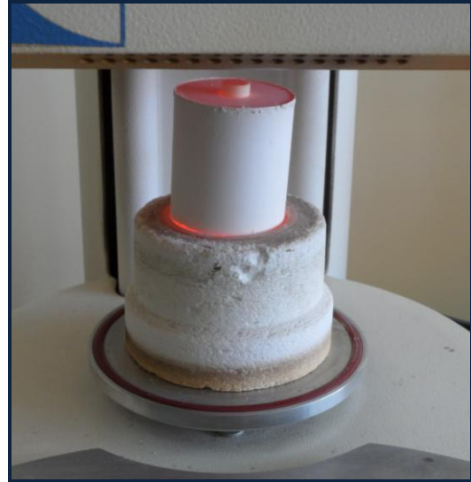
Şekil 2.19. Fırın içerisine yerleştirilmiş revetman manşet
