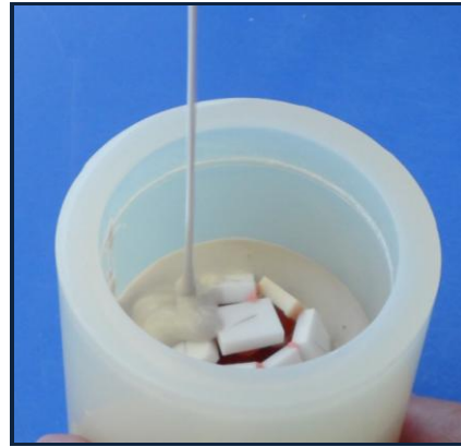
Şekil 2.16. Manşet içerisine revetman dökümü
