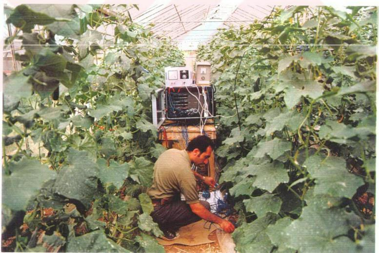
Şekil 4.7. Deney standı elektriksel iletişim kablolarının veri toplama sistemine bağlanması
