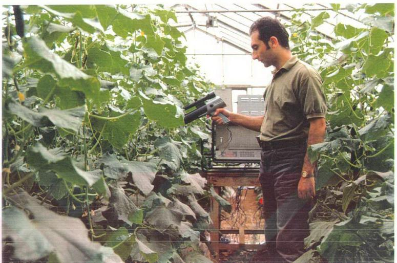
Şekil 4.8. Omega OS-2000A infrared pirometresi ile yaprak yüzey sıcaklığının ölçülmesi
