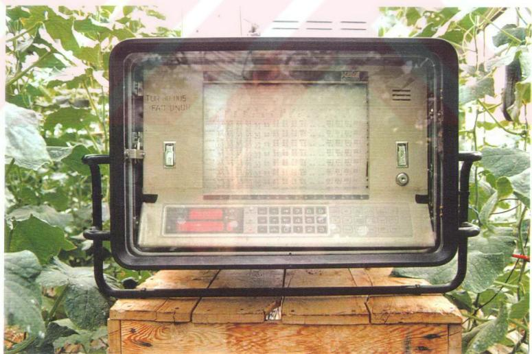
Şekil 4.5. Kaye Instruments Digistrip II digital veri toplama sistemi
