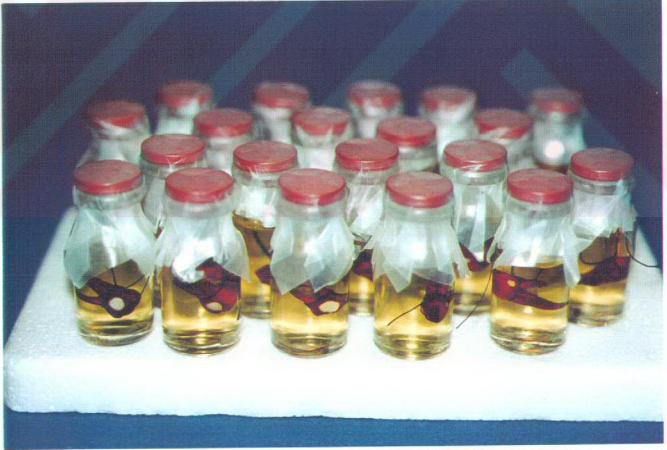
Resim 7 : Asidifiye jelatin jel içine atılmış Fuji II LC ve F2000 materyaline ait deney örnekleri
