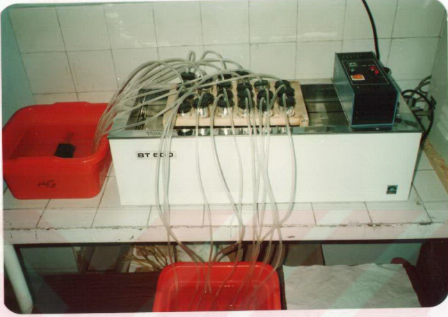
Şekil 3.8. in-Vitro Sindirim Denemesi, Su Banyosunda inkübasyona Bırakılmış Tüpler
