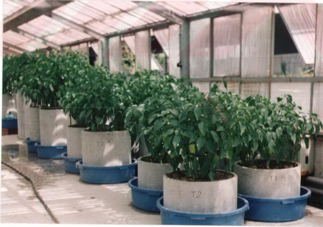
Şekil 3.1. Lizimetre olarak kullanılan deneme kolonları
