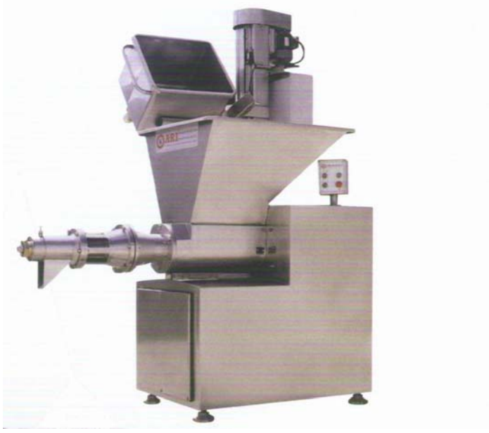
Şekil 1.2. Broiler Etlerinde Mekanik Olarak Ayırma İşlemi Yapılan Burgu Tipi Makina
