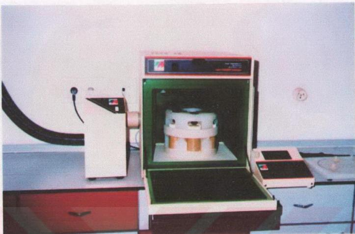
Resim 3.5. MDR 1000/6 mikrodalga yüksek basınç rotoru
