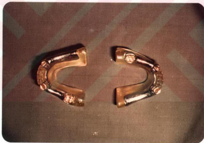
Resim 5: Foto-Elastik Modeller Üzerine Yerleştirilen
