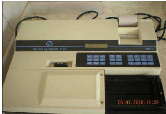
Şekil 3.10 ELISA değerlerinin okunduğu spektrofotometre
