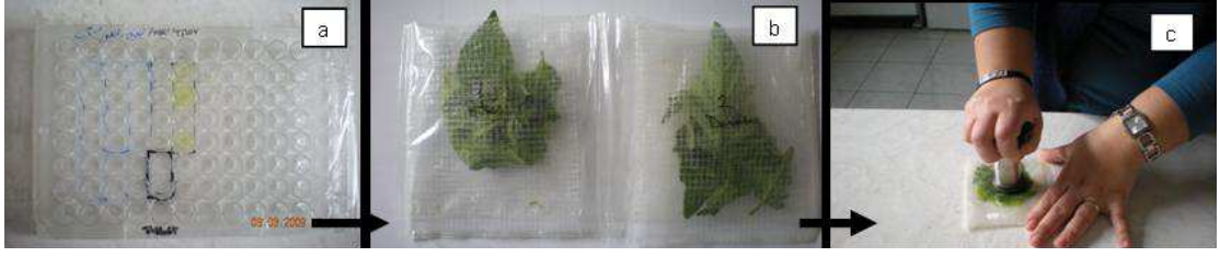
Şekil 3.9 a.ELISA plate, b.özel örnek poşetleri, c.örnek poşetlerine konmuş aprakların el homojenizatörü ile ezilmesi
