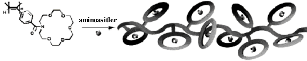
Şekil 2.59 Enantiyomerik saflık ölçümlerinde kullanılan lariat taç eterlerin helis oluşturmaları
