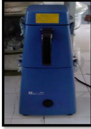
Şekil 3.2 Yüksek hızlı değirmen (IKA M20 Universal Mill)
