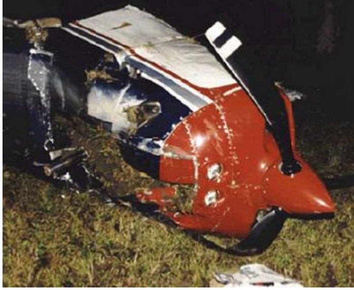
Şekil 1.26 Pervanede İleri Hıza Nazaran Düşük RPM ya da Sıfır RPM (Kaza Kırım İnceleme Kursu Ders Notları, 2003)
