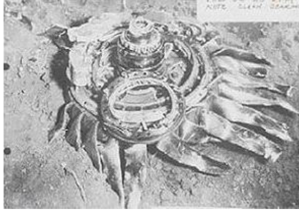
Şekil 1.31 Şiddetli Çarpma ve Sıfır RPM (Kaza Kırım İnceleme Kursu Ders Notları, 2003)
