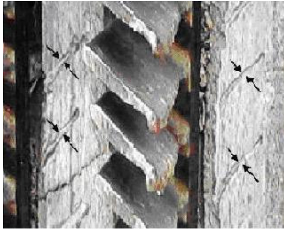
Şekil 1.30 Düşük Şiddette Çarpma ve Düşük RPM. Cidarlarda Kanatçık İzleri (Kaza Kırım İnceleme Kursu Ders Notları, 2003)
