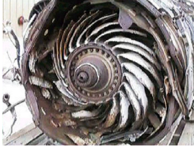
Şekil 1.27b Kanatçıkların Dönü Yönünün Tersine Bükülmesi.Yüksek RPM (Kaza Kırım İnceleme Kursu Ders Notları, 2003)
