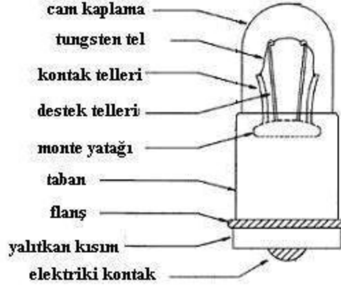
Şekil 1.37 Lambanın Yapısı (Galler ve ark.1995).
