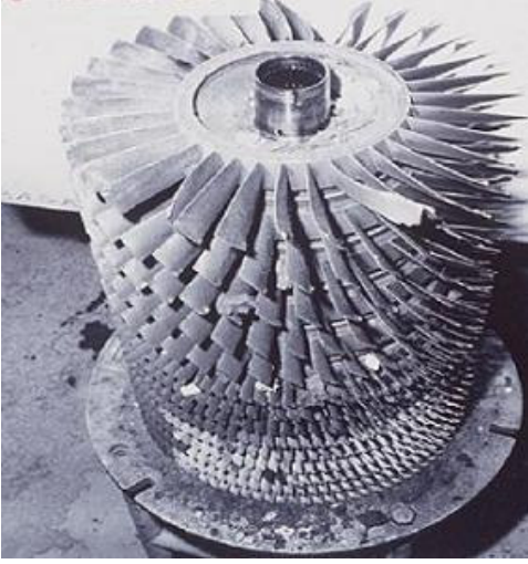
Şekil 1.28 Düşük Şiddetli Çarpma ve Yüksek RPM (Kaza Kırım İnceleme Kursu Ders Notları, 2003)
