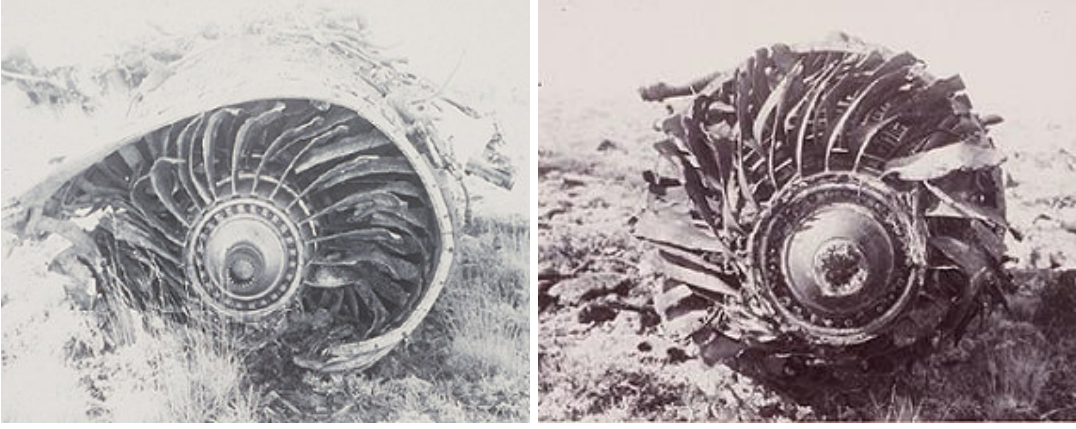
Şekil 1.29 Şiddetli Çarpma ve Düşük RPM (Kaza Kırım İnceleme Kursu Ders Notları, 2003)
