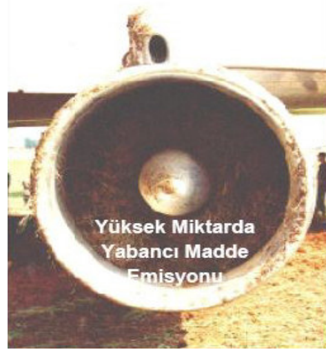
Şekil 1.28 Düşük Şiddetli Çarpma ve Yüksek RPM (Kaza Kırım İnceleme Kursu Ders Notları, 2003)
