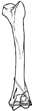
Şekil 1.28. İnterfragmental kompresyon vidası ile kombine olan Kirschner teli uygulaması (Montavon ve ark., 2009).
