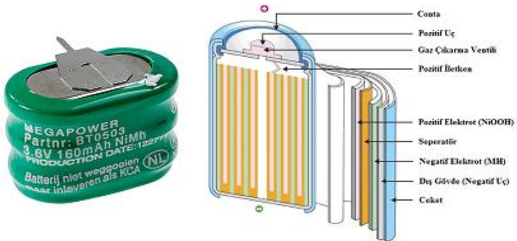
Şekil 1.3 Örnek nikel-metal hidrür batarya ve pil iç yapısı (Anonymous 2015a)
