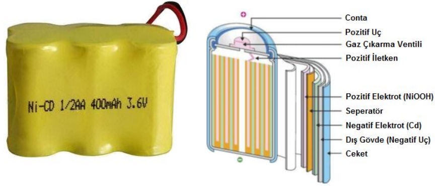
Şekil 1.2 Örnek nikel-kadmiyum batarya ve pil iç yapısı (Anonymous 2014)
