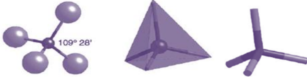
Şekil 2.13 Zeolitlerde temel yapı birimi \text{SiO}_4 ( \text{AlO}_4 ) dörtyüzlülerinin farklı şekillerde gösterimi
