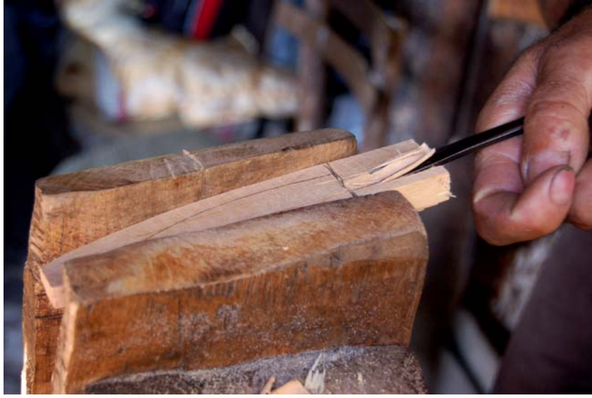
Fotoğraf 15: Kâzım Usta iskarpela ile sap oyuğunu açıyor.
