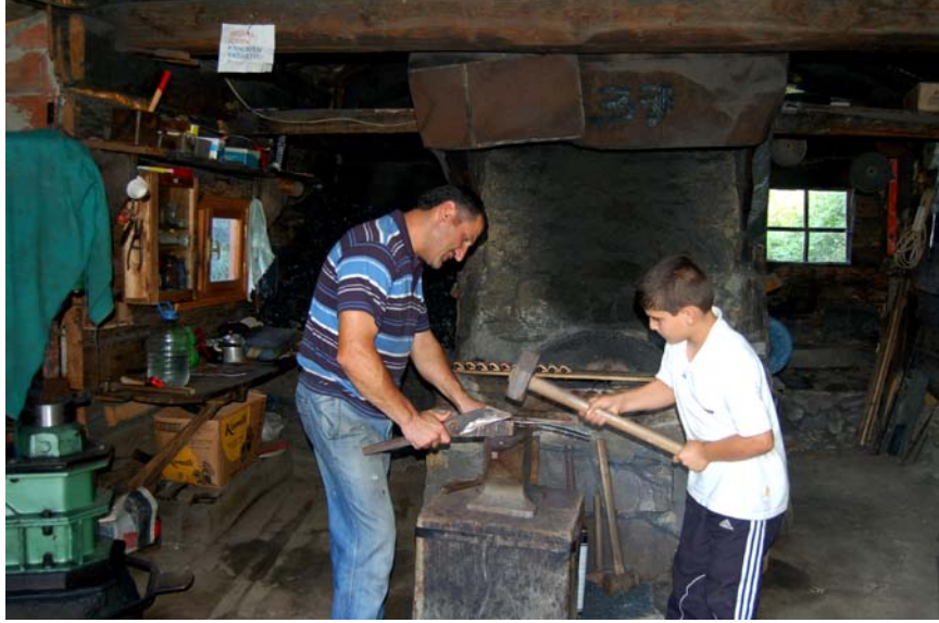
Fotoğraf 45: Muhtarın Mehmet Usta ve Oğlu Furkan, araba makasından parça kesiyorlar.
