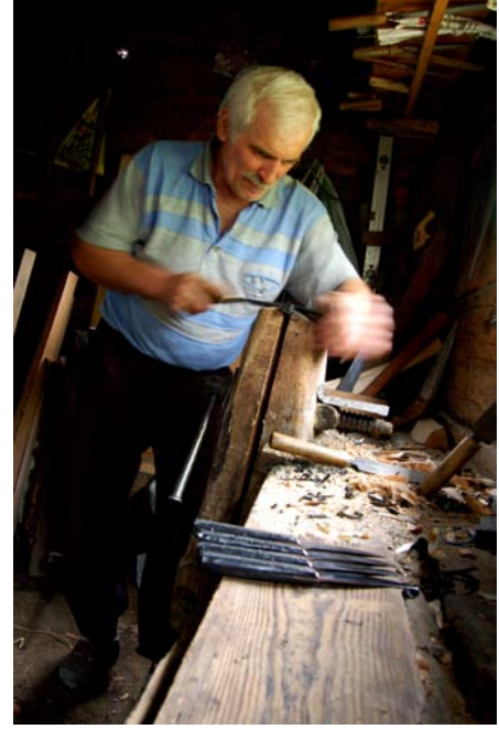
Fotoğraf 53 – 54: Mehmet Usta köyün en parlak ve sağlam çeliğinden olan bıçaklarına sap takıyor
