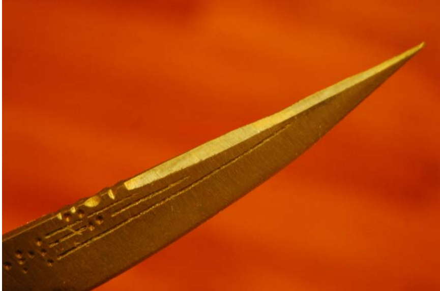
Fotoğraf 36: Sivri bıçak üzerinde sırtın inceltilerek süslenmesi örneği
