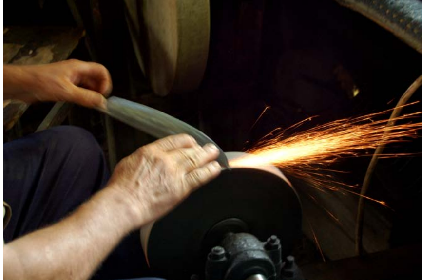
Fotoğraf 7: Mustanın Mehmet Usta yaldız köseresinde bıçak parlatıyor
