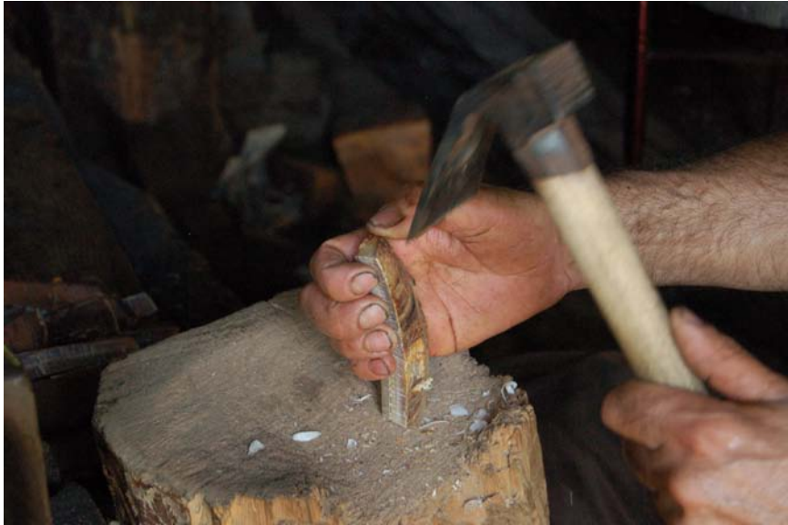
Fotoğraf 10: Kâzım Usta ısıtılmış boynuzun kabasını alıyor.
