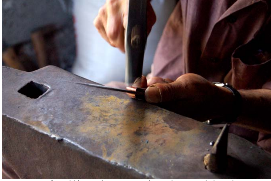
Fotoğraf 13: Okloğ Mehmet Usta sapla namlu arasına bakır çakıyor.
