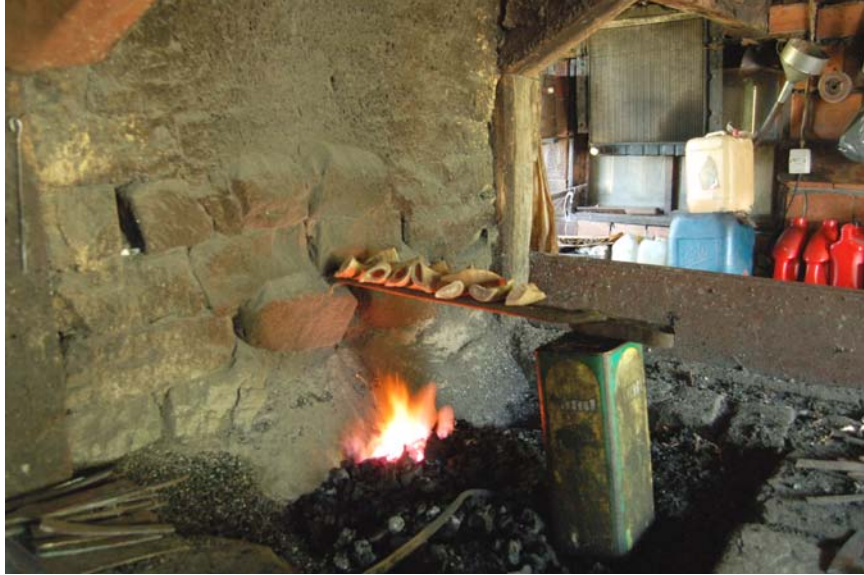
Fotoğraf 8: Kâzım Usta düzeltereği boynuzları ısıtıyor.
