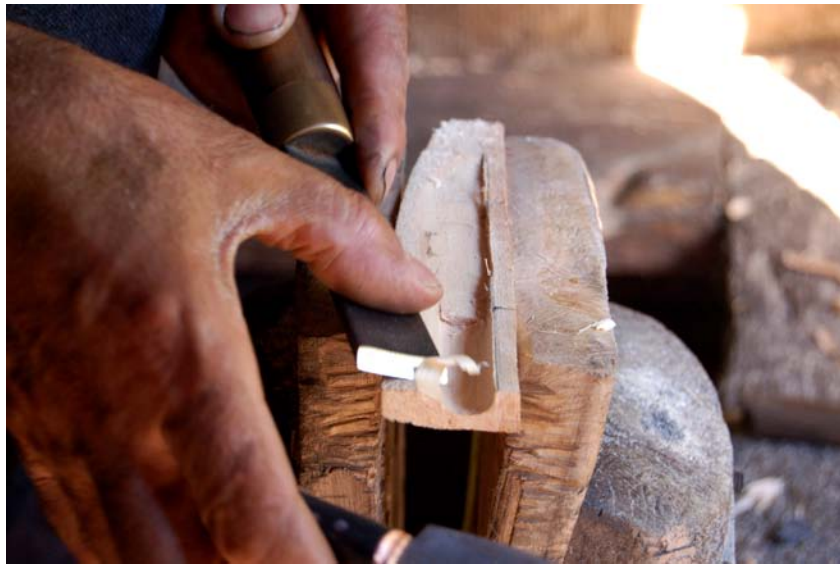
Fotoğraf 16: Kâzım Usta kınayı tarak demiri ile oyuyor.
