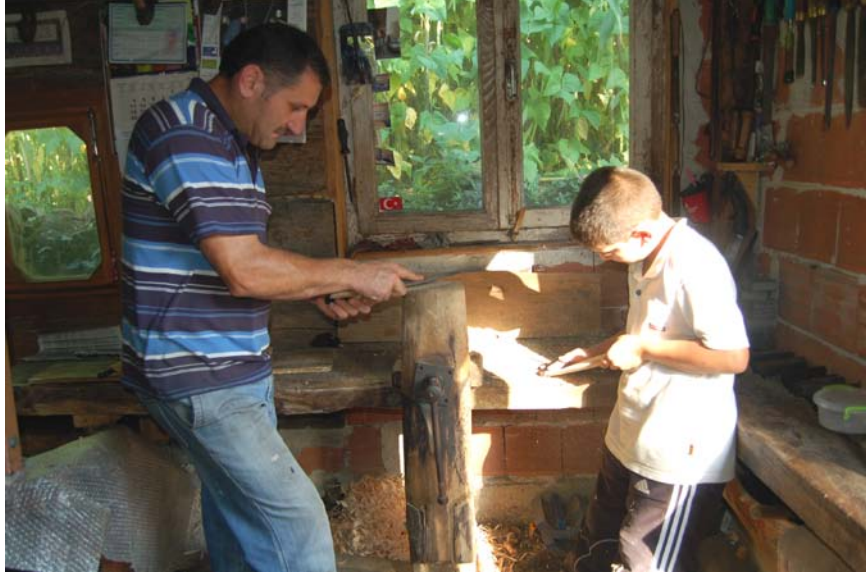
Fotoğraf 48: Mehmet Usta kınayı eğeden geçirirken Furkan zımparalıyor.
