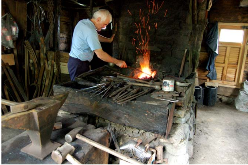
Fotoğraf 51: Mustanın Mehmet Usta dövme için demir ısıtıyor.
