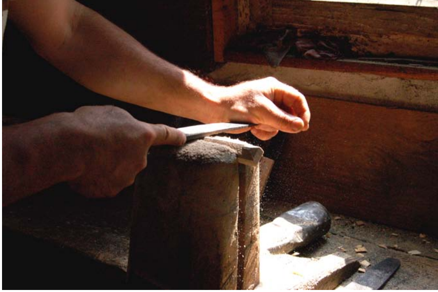
Fotoğraf 49: Muhtarın Mehmet Usta sipariş aldığı ekmek bıçaklarının gürgen sapını törpülüyor
