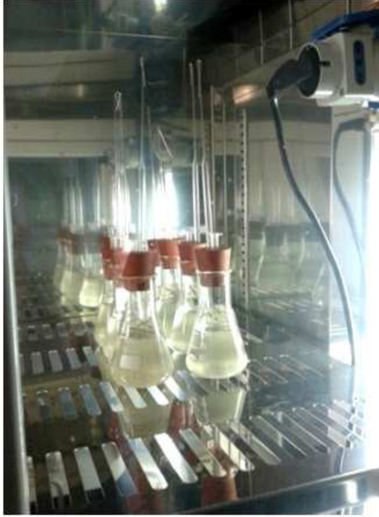
Şekil 3.6 İnkübatöre konulan yapay üzüm şirasında fermantasyon deneyi örnekleri
